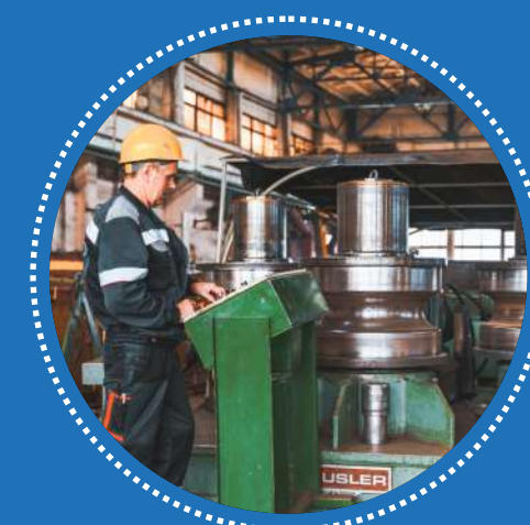
Профилегибочная машина HPR 1100 максимальный размер балки 350 мм
