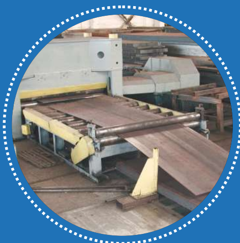
11-и валковая листопрямляющая машина UBR-16 максимальной шириной листа 3 000 мм
