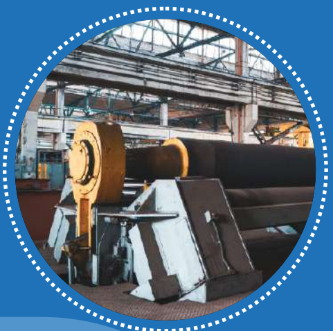
4-х валковые листогибочные машины максимальной шириной листа 3 150 мм и толщиной до 40 мм
